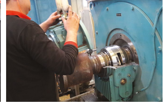
2500 kW atlas copco kompresör motoru sahada yatak değişimi ve laser kaplin ayarı.
