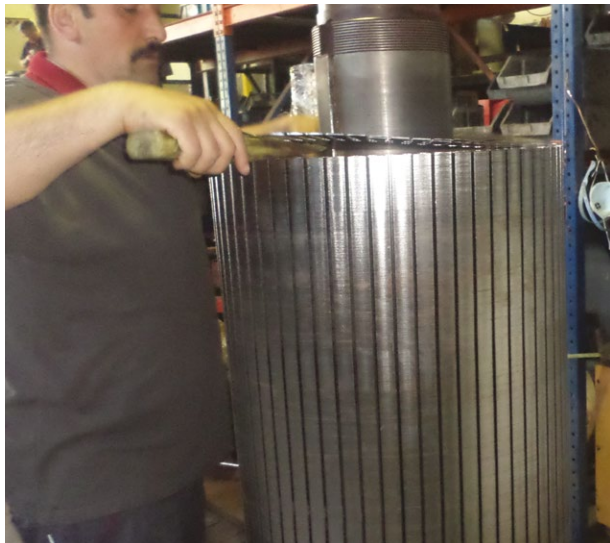
1475 kW Pompa motoru rotor nüve imali ve yeniden sarımı.
