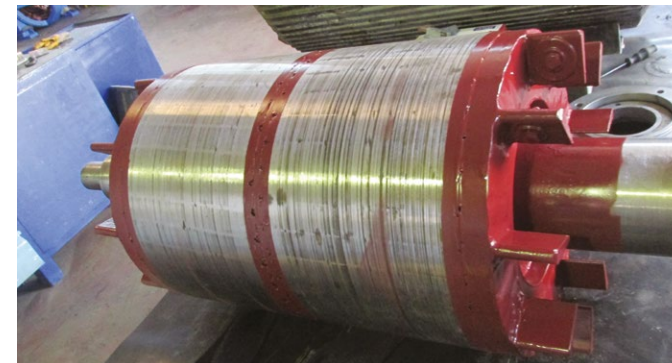
181 kW atlas copco kompresör Siemens marka motor sarımı, çift loblu rotor sarımı.
