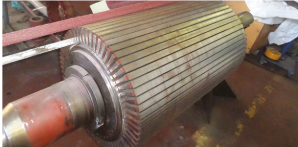
Tuzla arıtma 4360 kW Generatör saha bakımı.
