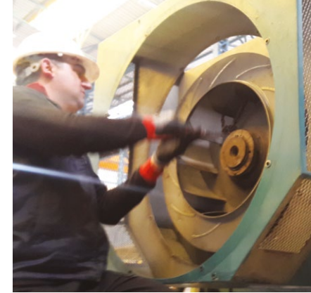
2500 kW atlas copco kompresör motoru sahada yatak değişimi ve laser kaplin ayarı.
