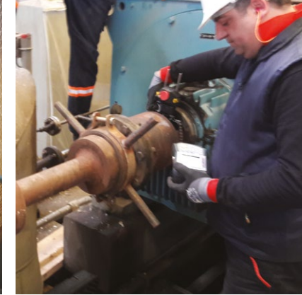
2500 kW atlas copco kompresör motoru sahada yatak değişimi ve laser kaplin ayarı.
