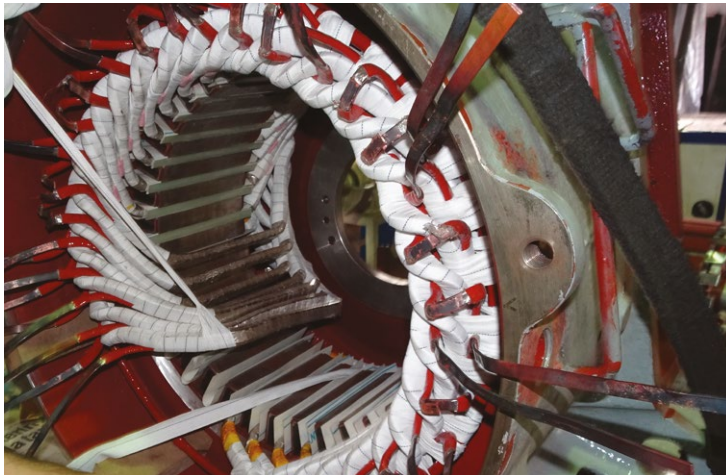
150 kW AC traction motor stator sarımı işimiz.
