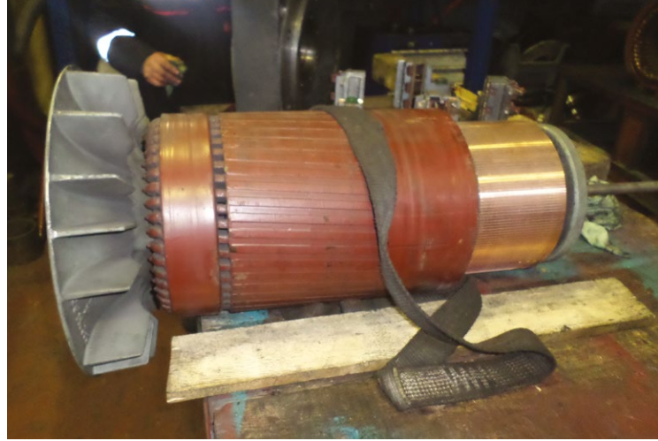
128 kW DC traction motor stator sarımı işimiz.
