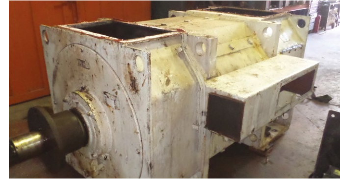
735 kW DC pompa motoru, atelye ve saha servisi bakım ve onarım işimiz.
